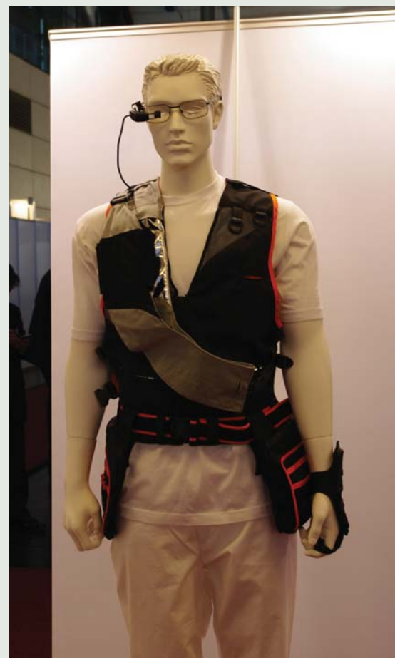
Специальный планшетный облегченный компьютер iWEAR , прикрепляемый на пояс сбоку
